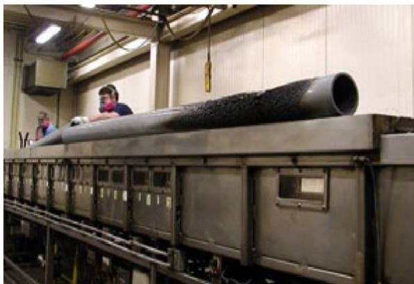
เครื่องทดสอบการลามไฟและการกระจายควัน (มยพ. 8206-52)
